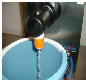
..... Typ RA: Drücken Sie die Reinigungstaste. Die Nachreinigung läuft ab
