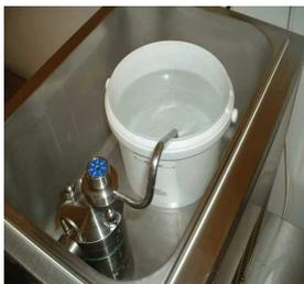
Stellen Sie den Spültopf in die Maschine und schwenken das Saugrohr ein
