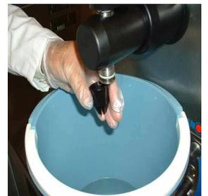
Entfernen Sie die Garniertülle
