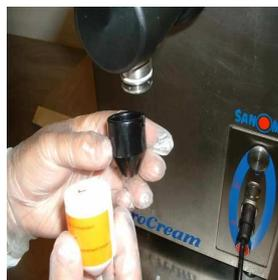
Ersetzen Sie die Reinigungsdüse durch die Garniertülle
