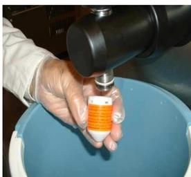
Setzen Sie die Reinigungsdüse auf
