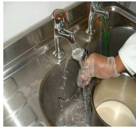
Entnehmen Sie Sahnetopf und Saugrohr und spülen Sie beides gründlich unter fließend heißem Wasser
